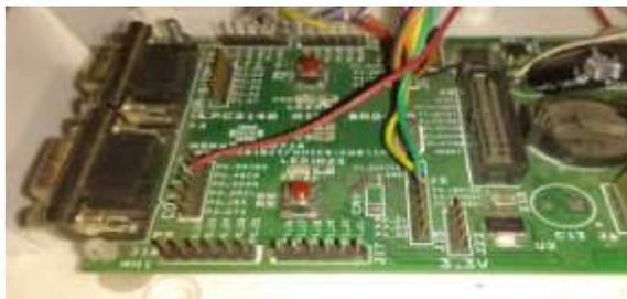
Fig.6. ARM 7 controllers Board ckt.
