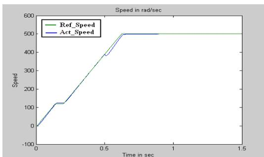
Fig. 4 (d) Speed for Conventional DTC
