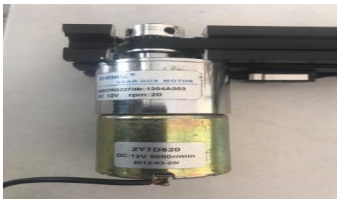
Fig. 5 12V DC Gear motor (ZYT520)
